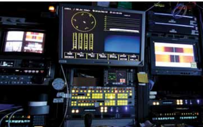
חדר הבקרה/שליטה באניה נאוטילוס. מחדר זה מתבצע תפעול הצוללות הבלתי-מאוישות, הרקולס וארגוס (ספטמבר 2010)
